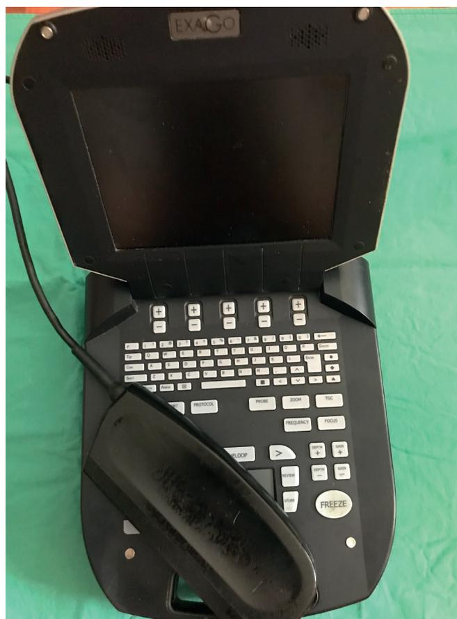
**Foto 4.** Si utilizza una sonda lineare da 3.5 MHz, di 17 cm: solo con questa lunghezza è possibile ottenere immagini ottime.
