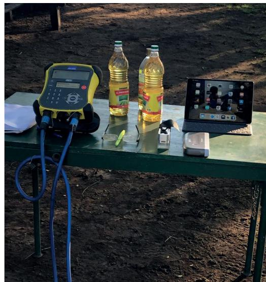
**Foto 2.** L'attrezzatura necessaria è semplice: un ecografo, una sonda, olio d'oliva, un computer.
